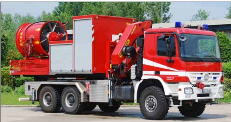
Das neue Wechselladerfahrzeug des THW Landau stammt von der Feuerwehr der Daimler AG, stationiert im LKW-Werk Germersheim. Der Actros 3341 ist hier beladen mit einem Abrollbehälter Belüftung. Als vorteilhaft erweist sich, dass der LKW bereits mit Sondersignalanlage, Ladekran 32 mt und zahlreichen Staukästen ausgerüstet ist. (Foto: Michael Mund)
