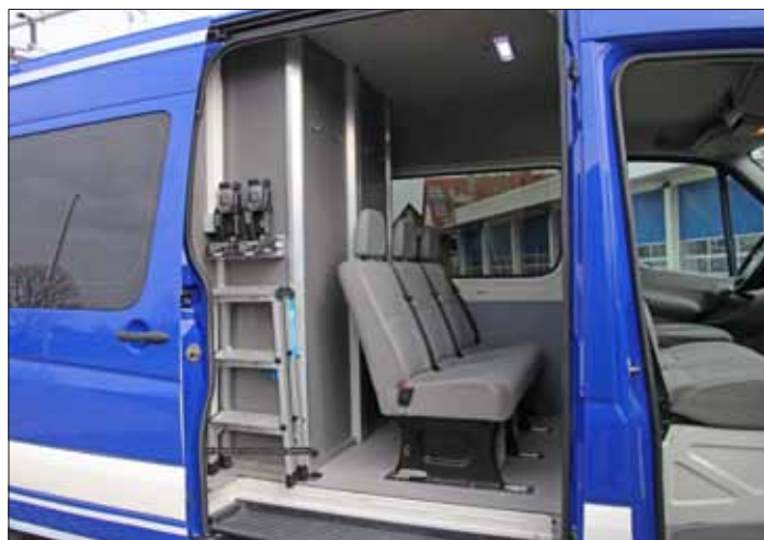
Grundlegender Umbau: Zuvor gab es hinter den Vordersitzen eine einfache Trennwand, jetzt kann mehr Personal mitfahren.
